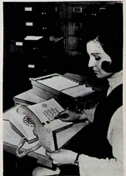
Afb. 2. Telefoontoestel met ingebouwd data-transmissie-systeem van RFT.
